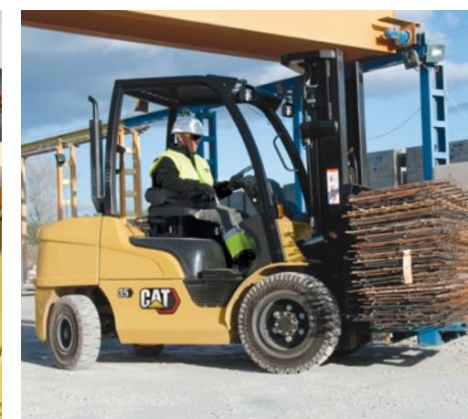
O gamă largă de dotări vă permite să adaptați stivitorul dumneavoastră Cat la aplicația dorită. Un filtru de aer dublu, de exemplu, este prevăzut pentru a asigura o protecție crescută a motorului în aplicații din medii cu praf, cum ar fi în mori sau depozite de cărămizi, iar inelele de ridicare optionale pot fi atașate pentru a permite ridicarea stivitorului pe un vapor sau autocamion pentru aplicații portuare sau mobile.
