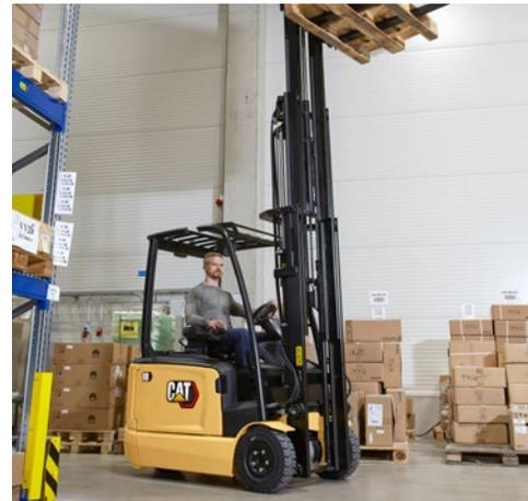
**Das Load-Sensing-Hydrauliksystem stellt sich automatisch auf das Gewicht der Last ein, um präzise Kontrolle zu gewährleisten. Eine passive Schwankkontrolle hält die automatische Feststellbremse offen, sodass die Schwankenergie des Hubgerüsts von der Masse des gesamten Staplers aufgenommen wird. Alle Hubgerüste und die reibungsarme Seitenschubvorrichtung minimieren Schwanken, Verdrehungen und Geräusche.**
