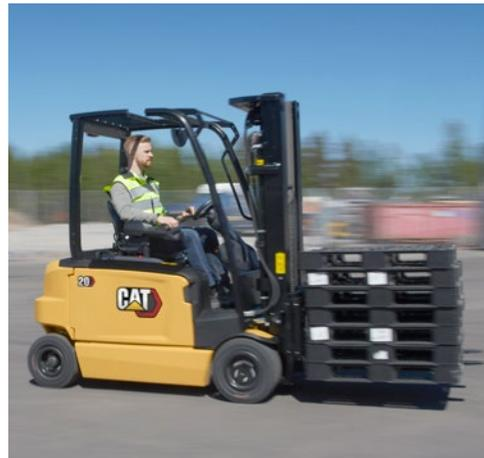
**Das *Responsive Drive System 2 (RDS2)* reagiert sofort auf Änderungen der Geschwindigkeit der Pedal- und Hydrauliksteuerungsbewegung. Das bedeutet, dass alle Aktionen reibungslos gesteuert werden, einschließlich Kurvenverhalten, Stopps und Anfahren.**
