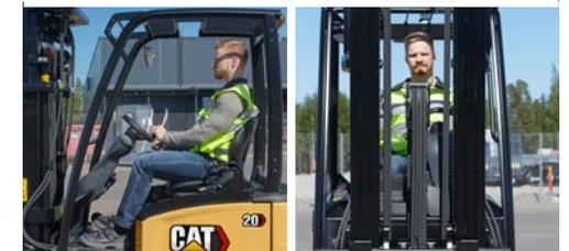
**Sitz und Lenksäule sind verstellbar und gewährleisten eine perfekte Fahrposition für Fahrer jeder Größe. Die Sicht nach vorne, nach unten und zu den Seiten ist hervorragend, dank einer speziell entwickelten Freihubzylinderkonstruktion, bei der Schläuche und Ketten so angeordnet sind, dass Sichthindernisse minimiert werden. Zu den ergonomischen Bedienelementen gehören eine verstellbare Armlehne mit integrierten Fingertip-Hebeln, sowie Pedale, die geringe Ermüdung gewährleisten.**
