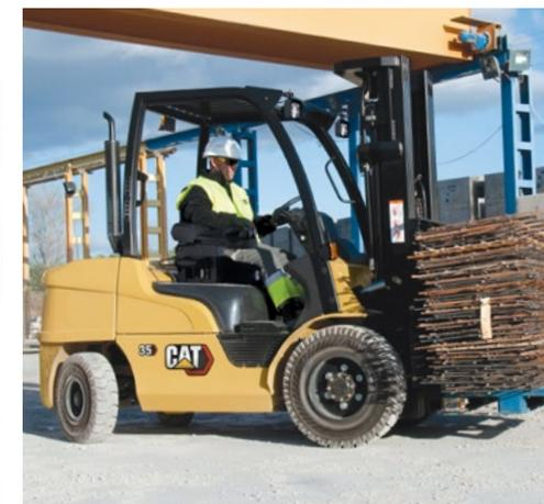
Un large éventail de fonctionnalités vous permet d'adapter les caractéristiques de votre chariot élévateur Cat à votre application. Le filtre à air double éléments, par exemple, protège mieux le moteur dans les environnements poussiéreux tels que les aciéries ou encore les usines de briques. Quant aux crochets d'élingue, disponibles en option, ils permettent de convoyer le chariot sur un bateau ou un camion pour les applications portuaires ou mobiles.
