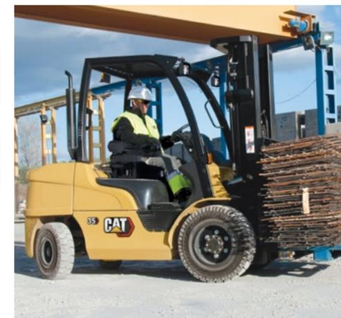
Širok raspon značajki omogućuje vam da uskladite specifikacije Cat® viličara s vašom primjenom. Primjerice, ugrađen je dvostruki filter zraka za pružanje poboljšane zaštite motora u prašnjavim uvjetima, kao što je u kamenolomima i ciglanama, a mogu se pričvrstiti i opsijske alke za podizanje kako bi se omogućilo podizanje viličara na plovilo ili labudicu za lučku ili mobilnu uporabu.
