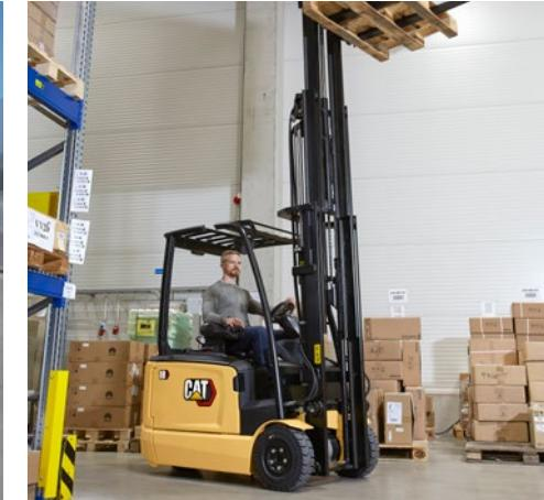
Hidraulični sustav sa senzorom opterećenosti automatski se prilagođava teretu koji se prevozi, a sve kako bi se održala precizna kontrolna. Upravljanje pasivnim njihanjem radi na način da održava automatsku parkirnu kočnicu otvorenom pa energiju njihanja mosta upija masa cijelog stroja. Svi stupovi i bočni pomak niskog trenja svode njihanje, uvijanje i buku na minimum.
