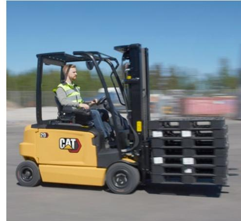
Opcija upravljanja pod kutom od 360° omogućuje bolju agilnost u okretanjima. Na taj način stroj može skretati i okretati se u suprotnom smjeru (180°) bez zaustavljanja i pritom se teret ne destabilizira (model s 3 kotača).
