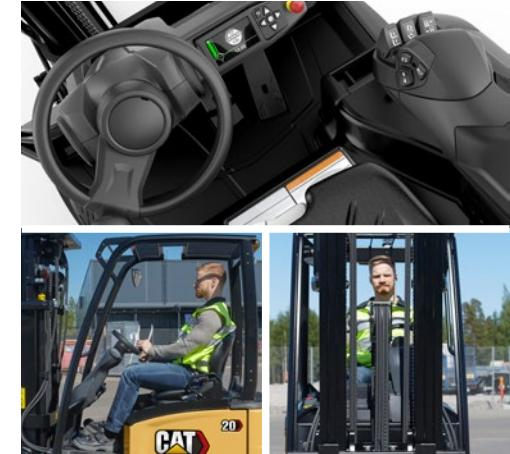
Podesivo sjedalo i stup upravljača osiguravaju idealan položaj za vožnju vozačima svih tjelesnih proporcija. Izvrsnu vidljivost sprjeda, prema dolje i u stranu jamče posebno dizajnirana konstrukcija cilindra za slobodno podizanje kod koje su crijeva i lanci postavljeni na način da smanjuju prepreke vidljivosti na minimum. Ergonomski komandi uključuju podesiv naslon za ruke s ugrađenim ručicama za upravljanje dodirom prsta te komplet papučica koje ne stvaraju zamor.
